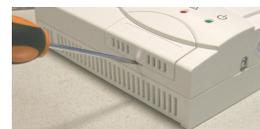
1\_ Spegner il rivelatore scollegandolo dalla rete di alimentazione e con l'aiuto di un cacciavite fare leva nell'apposita fessura per rimuovere il coperchietto posto sotto i tre LED.
