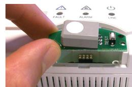
3\_ Estrarre il **Modulo sensore** da sostituire.
