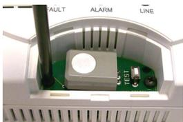
2\_ Svitare le due viti di fissaggio del **Modulo sensore** da sostituire.
