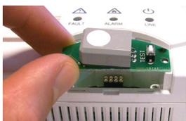
3\_ Estrarre il **Modulo sensore** da sostituire.
