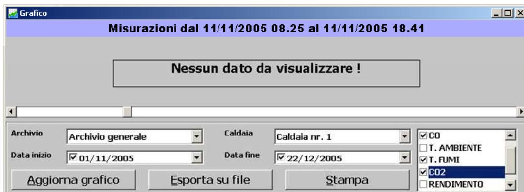
Se scorrendo il grafico appare il messaggio sopra illustrato, significa che in quell’intervallo di tempo non ci sono dati, ad esempio perché la caldaia era spenta o se l’AN750 è stato spento. In questo caso verificare gli **eventi**.
