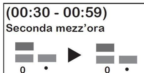
Dunque: La programmazione della temperatura nella SECONDA MEZZ'ORA di ogni ORA, NON comporta nessuna modifica alla colonna dell'ORA corrispondente, anche se viene impostata una temperatura differente rispetto alla temperatura della PRIMA MEZZ'ORA. Sul display otterremo un andamento grafico delle temperature programmate durante l'arco della giornata. A seconda dell'ORA in cui ci si trova, lampeggia il cursore della temperatura corrispondente.
